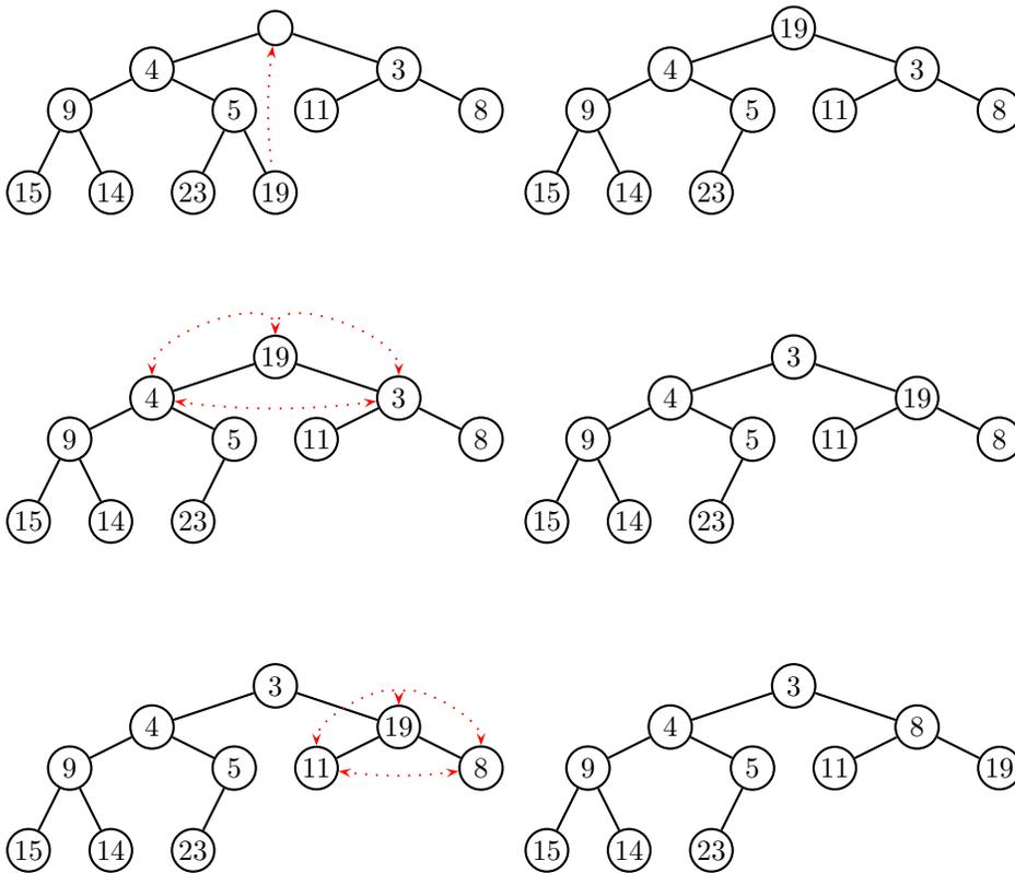
L'operazione di EXTRACT-MIN( $S$ ) in uno heap:
