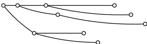
Notiamo che il figlio sinistro del nodo memorizzato nell'entrata  $i$  del vettore si trova nell'entrata  $2i$ , ed il figlio destro nell'entrata  $2i + 1$ . Analogamente, il padre si trova nell'entrata  $\lfloor i/2 \rfloor$
