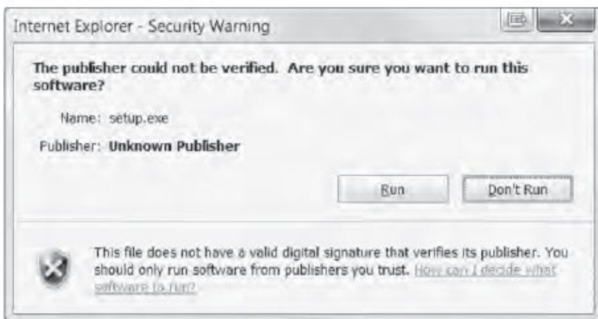
Figura 9.1 Il vostro computer controlla automaticamente le firme digitali. In alto: il messaggio che mi mostra il mio browser quando cerco di scaricare ed eseguire un programma che ha una firma digitale valida. In basso: il messaggio nel caso di firma digitale non valida o mancante.
